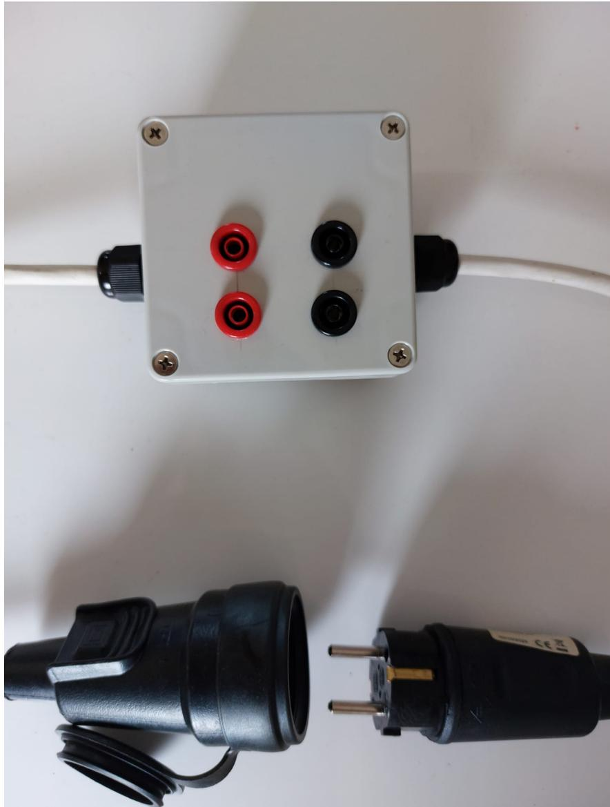
Abbildung 9.2: Abbildung der Box für die Messung am Desktop PC
