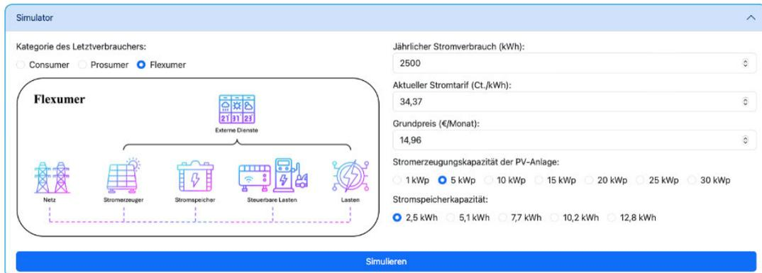
Abbildung 20: Benutzeroberfläche der Simulationsanwendung „Smart Grid Strategist“
