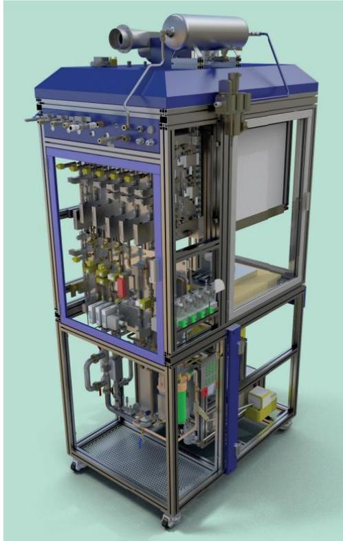
Abbildung 7: Teststand mit anhebbarer Haube der EBZ.Dresden [9]
