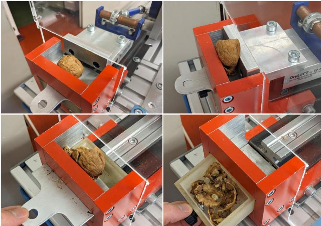
Abbildung 29: Verwendung des Nussknackers mit Aussparung
