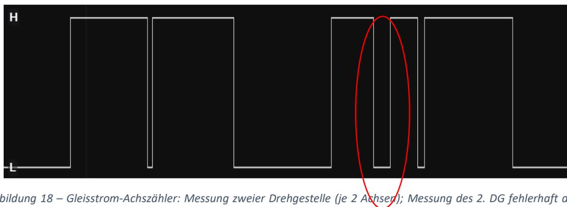
Abbildung 18 – Gleisstrom-Achszähler: Messung zweier Drehgestelle (je 2 Achsen); Messung des 2. DG fehlerhaft durch verschmutztes Rad
