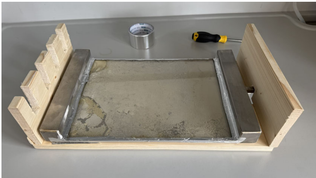
Abbildung 4.1: Foto des Photoreaktors mit beschichteter Platte und Glasabdeckung
