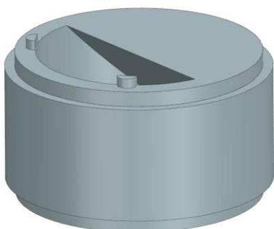
Abbildung 22: Mittlerer Teil Auffangvorrichtung mit Poka-Yoke-Prinzip (um 180° gedreht)
