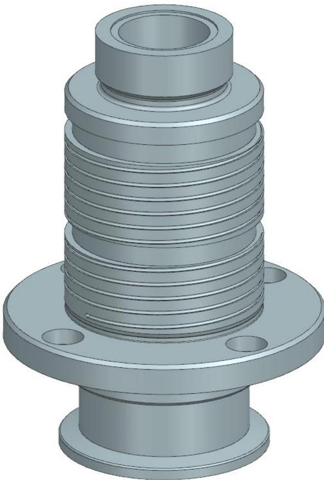
Abbildung 27: Endergebnis der Auffangvorrichtung mit Spiralnute
