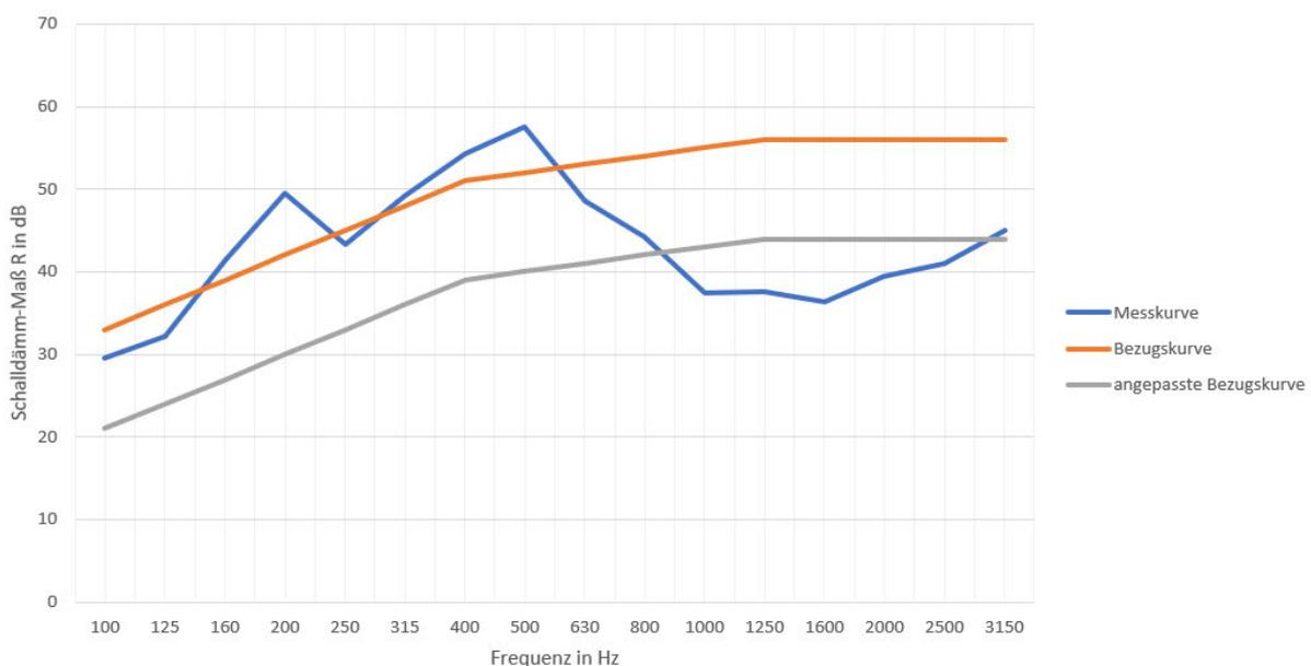
Abbildung 18: Messkurve, Bezugskurve und angepasste Bezugskurve zur Ermittlung des bewerteten Schalldämm-Maßes  $R_w$  im Regieraum (ohne Reifenschläuche)
