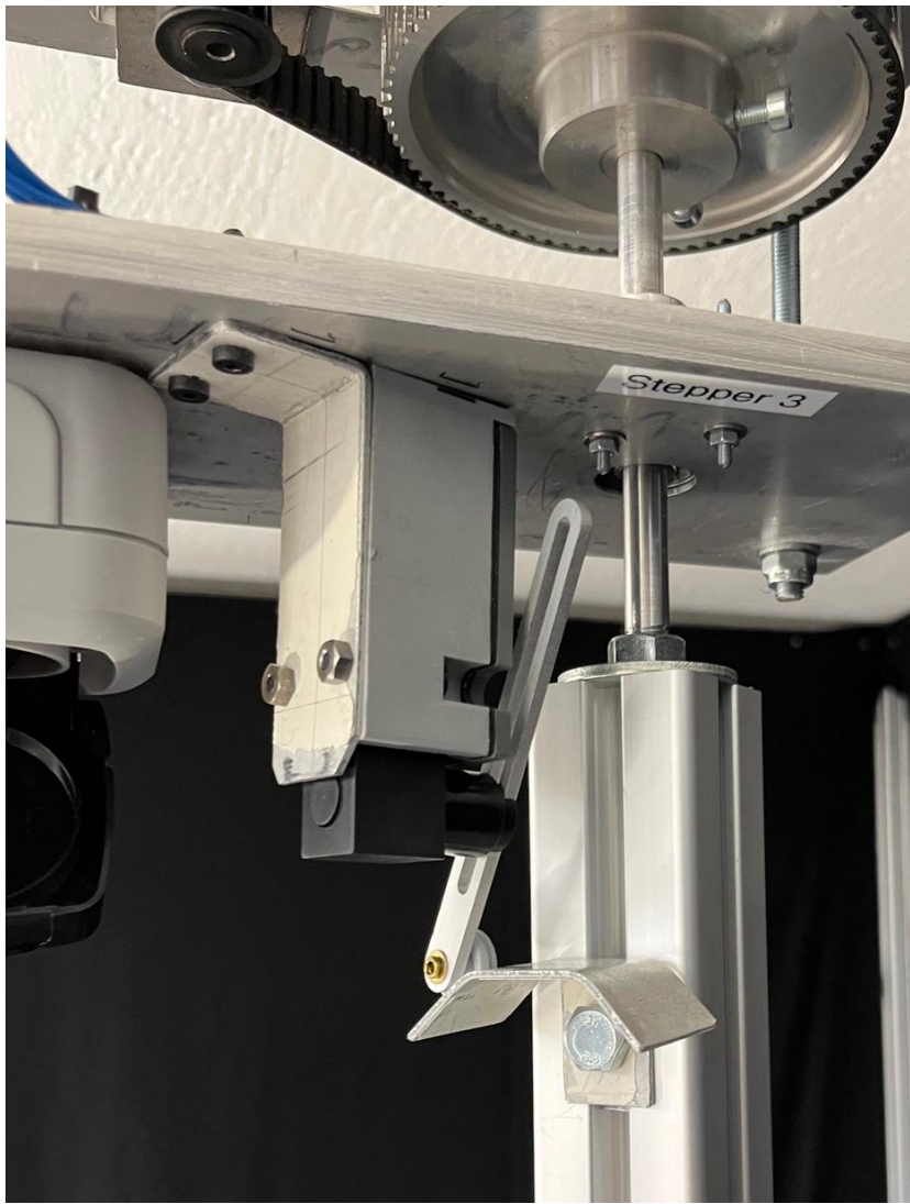
Abbildung 63: Grenztaster „Endstop fast“ für die Drehung der Leuchte
