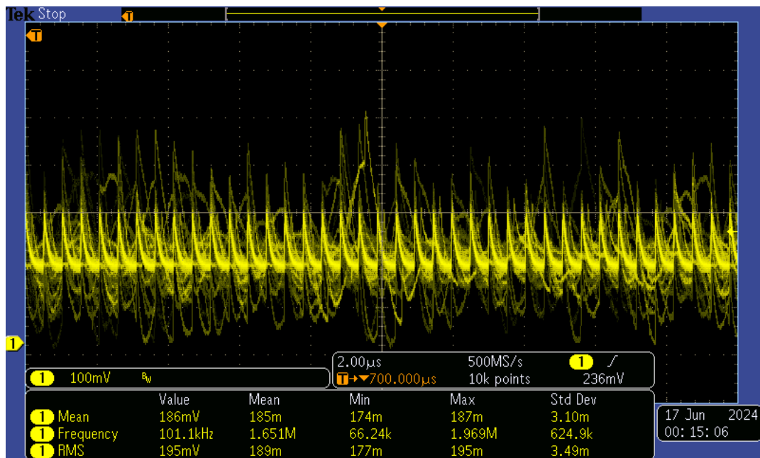
Abbildung 33: Messung vor dem Filter, deutliche Störung mit 2 MHz zu erkennen
