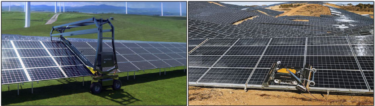
Abbildung 2.2 geführter Solarreiniger links und mobiler Solarreiniger rechts [21]
