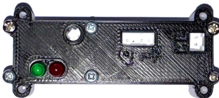
Abbildung D.1.: ECU-Modul mit Steckverbinder.
