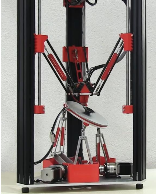
Abbildung 6: Delta-3D-Drucker mit einem neigbaren Druckbett [15]
