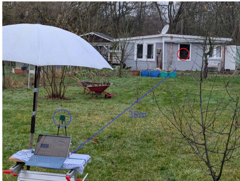
Abbildung 7.10: Beispielhafter Aufbau für den Reichweitentest bei 30 m
