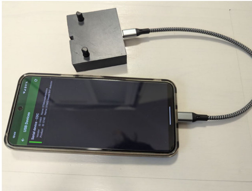
Abbildung 8.1: Mobiles Endgerät verbunden mit dem entwickelten Ultraschall Mikrophon-Array Adapter
