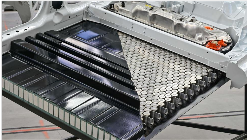
Abbildung 3.13: Cell2Pack Bauform der Traktionsbatterie [17]
