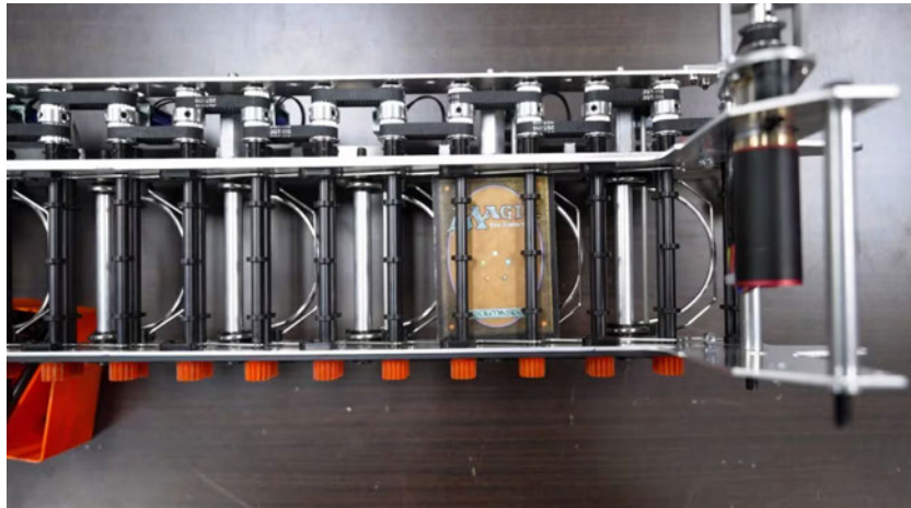
Abbildung 3.4: Transport mittels Reibrollen [27]
