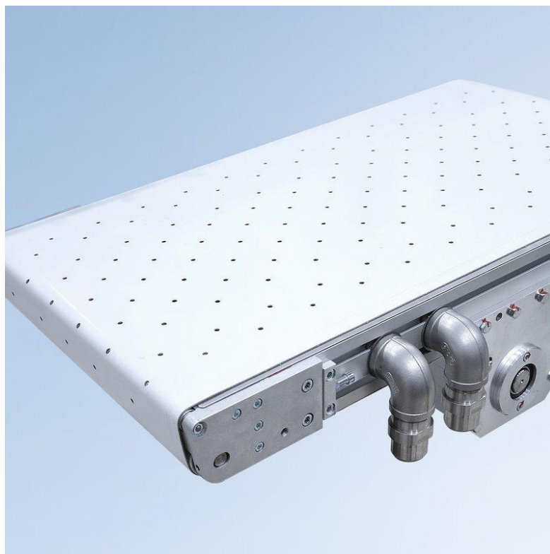
Abbildung 3.5: Transport mittels Vakuumförderband [28]
