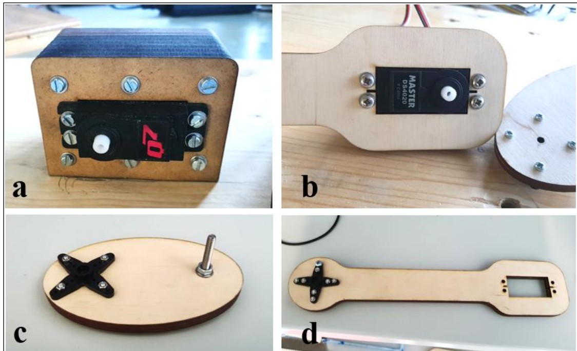
Abbildung 47: Einbau der Servomotoren und Darstellung der Holzelemente
