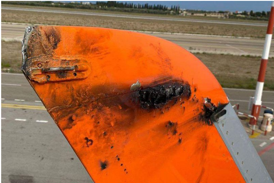
Abbildung 3.1: Durch Blitzeinschlag beschädigtes Winglet [24]
