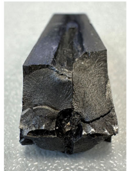
Abbildung 4.8 Aufweitdorn Kraftspuren (links) und Bruch (rechts)
