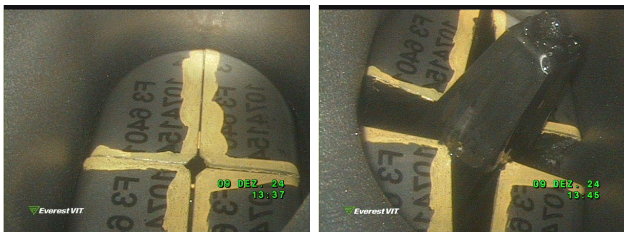
Abbildung 4.6 Endoskopaufnahmen des ersten Zylinders, links vor dem Aufweiten, rechts beim Aufweiten
