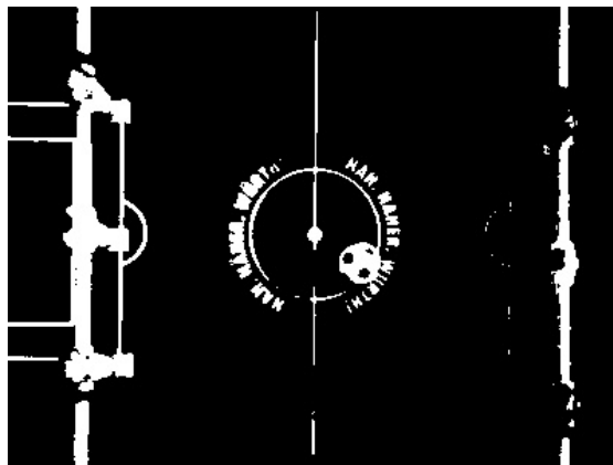
Abbildung 6.14: Binarisierung des Graustufenbilds über das Otsu-Verfahren
