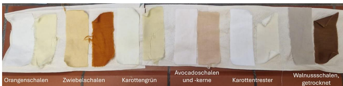
Abbildung 5: gefärbte Textilien nach der 1. Testfärbung und nach dem 1. Waschtest (eigene Darstellung)
