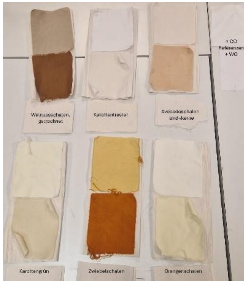
Abbildung 4: gefärbte Textilien nach der 1. Testfärbung, aber vor dem 1. Waschtest (eigene Darstellung)
