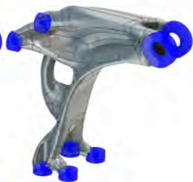
Anhang 81: Einstellungen der FE-Analysen am Beispiel der Optimierung Fusion Z-
