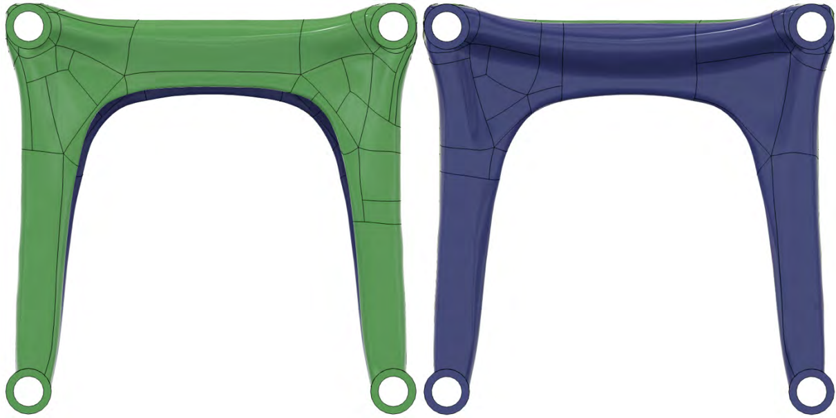
Abbildung 29: Optimierungsergebnisse Fusion. Grün uneingeschränkt, Blau mit Überhangswinkelrestriktion
