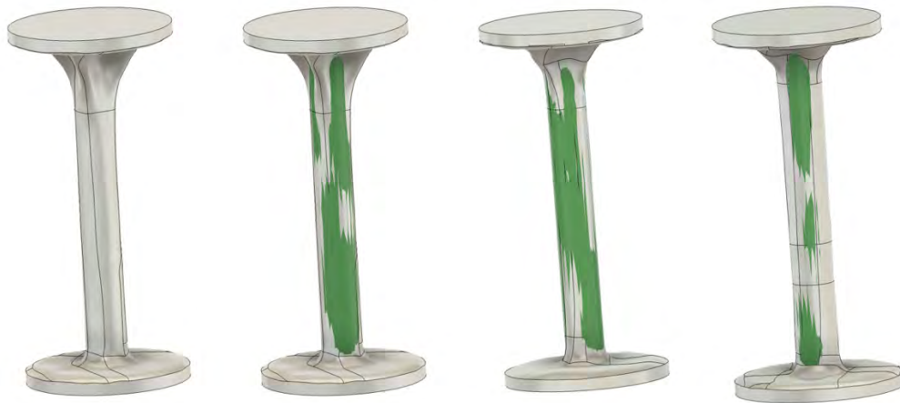
Abbildung 43: Ganz Links: Uneingeschränkte Geometrie. Dann, von links nach rechts, jeweils mit eingebettetem Zylinder des Durchmessers 2,4 mm in grün: Uneingeschränkte Geometrie, Mindestdicke 1 mm, Mindestdicke 2 mm
