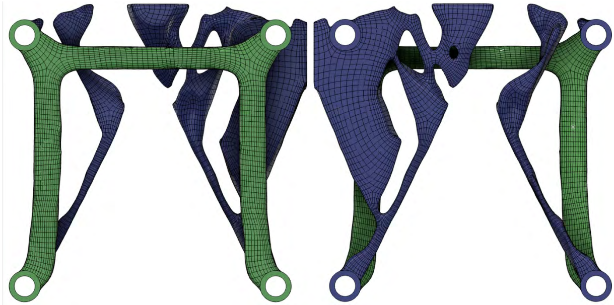
Abbildung 27: Optimierungsergebnisse Inspire, Blau mit gemilderter Überhangswinkelrestriktion, Grün uneingeschränkt
