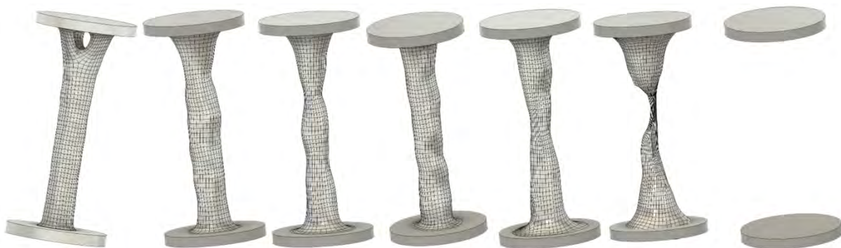
Abbildung 40: Von links nach rechts Optimierungen mit den vorgegebenen Mindestdicken: 2 mm, 3 mm, 4 mm, 5 mm, 6 mm, 7 mm, 8 mm
