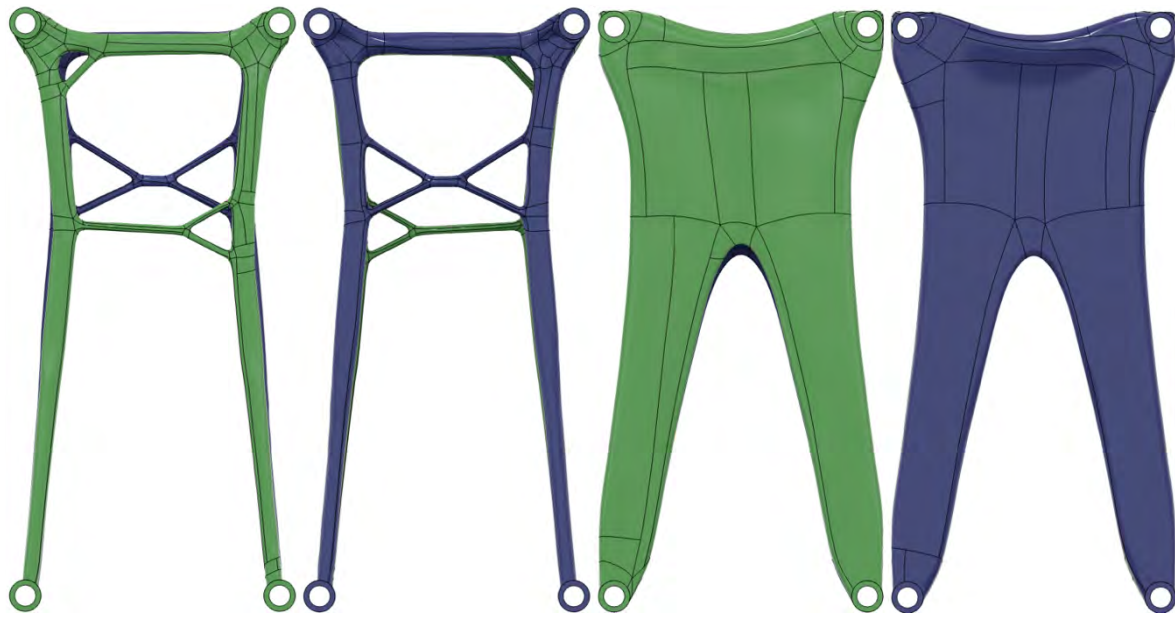
Abbildung 36: Optimierungsergebnisse Fusion, Durchlauf 1-4 von links nach rechts
