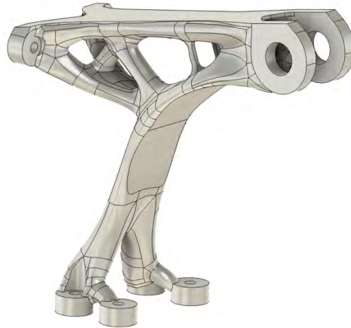
Abbildung 73: Uneingeschränkt optimiertes Optimierungsergebnis aus Fusion
