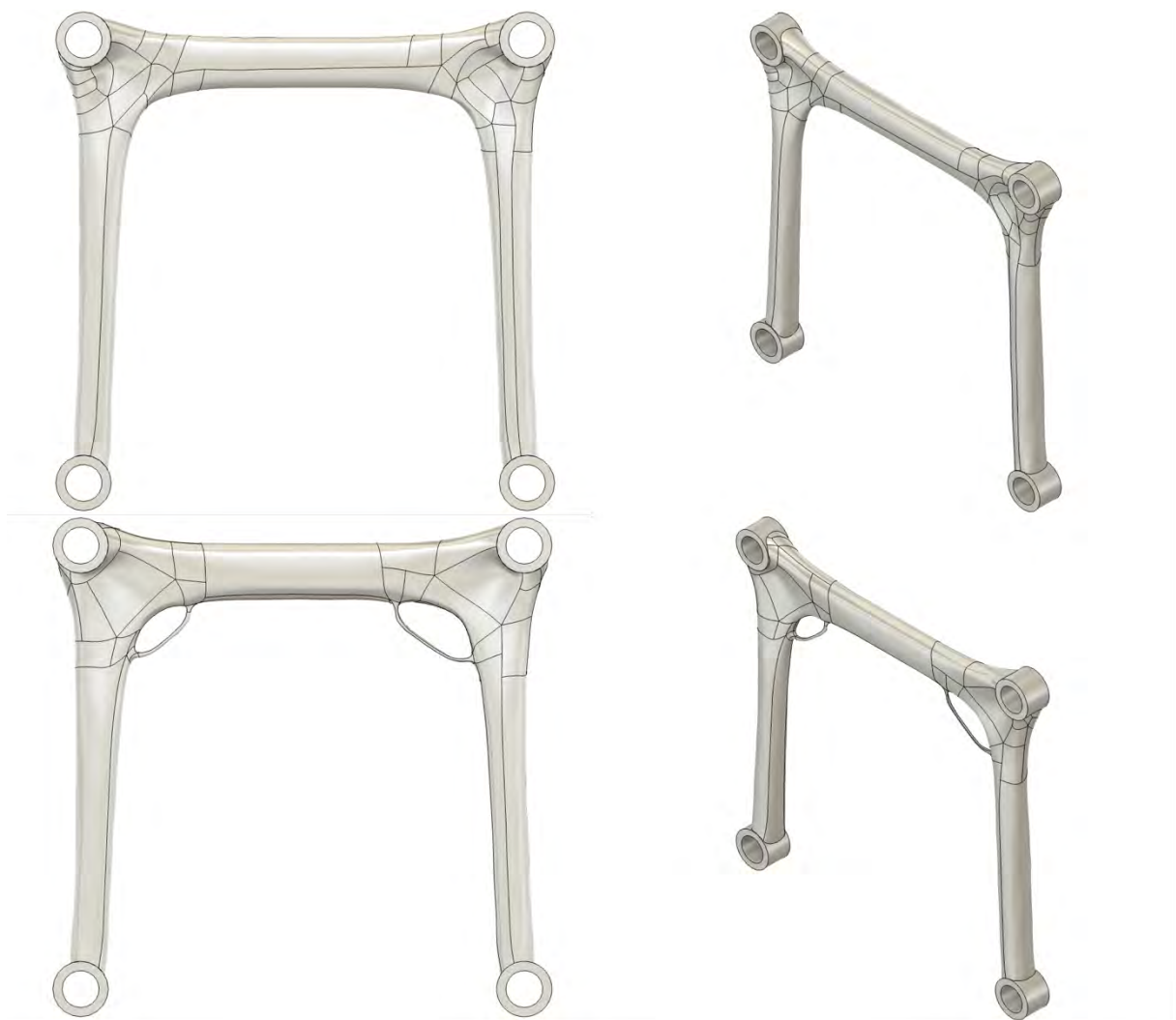
Anhang 13: Fusion: Oben uneingeschränkt, unten 45° Überhangswinkelrestriktion
