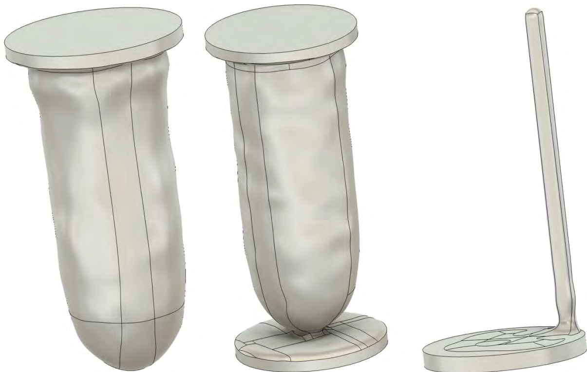
Anhang 44: Optimierungsergebnisse Apex, vorgegebener minimaler Durchmesser von links nach rechts: 4 mm, 5 mm, 10 mm
