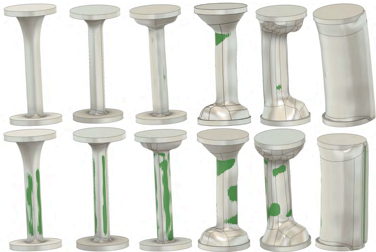
Anhang 49: Fusion-Optimierungsergebnisse mit Dickenrestriktion: Von links nach rechts, in Klammern der Zylinderdurchmesser oben und unten: uneingeschränkt (2,9 mm; 3 mm), 1 mm (2,7 mm; 2,8 mm), 3 mm (3 mm; 3,1 mm), 4 mm (3,9 mm; 4 mm), 5 mm (4,9 mm; 5 mm), 10 mm (9 mm; 9,1 mm)
