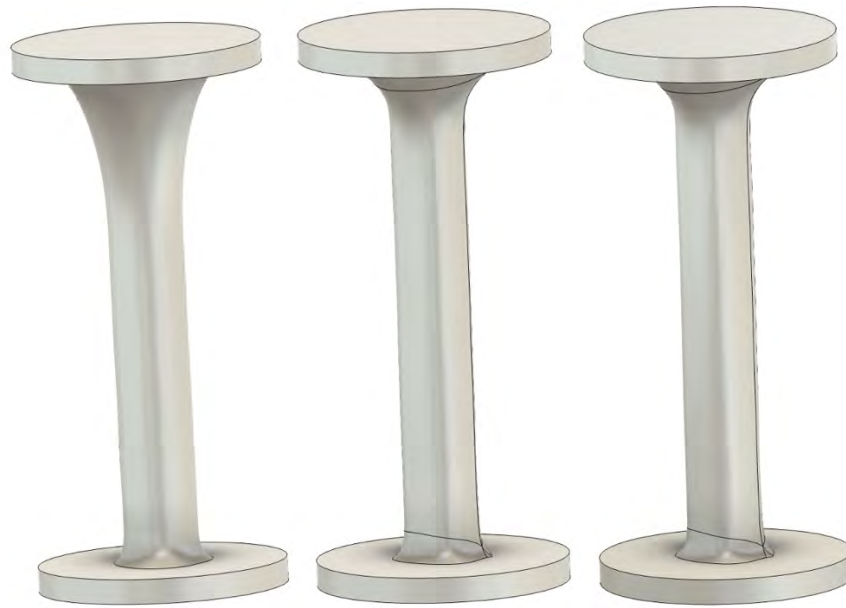
Abbildung 45: Ergebnisse für minimalen Dicke von: uneingeschränkt, 1 mm, 2 mm (von links nach rechts)
