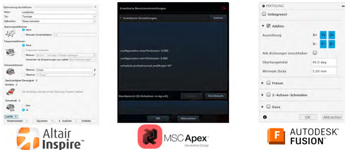
Abbildung 18: Einstellung für Fertigungsrestriktionen in der Topologieoptimierung in Apex, Fusion und Inspire
