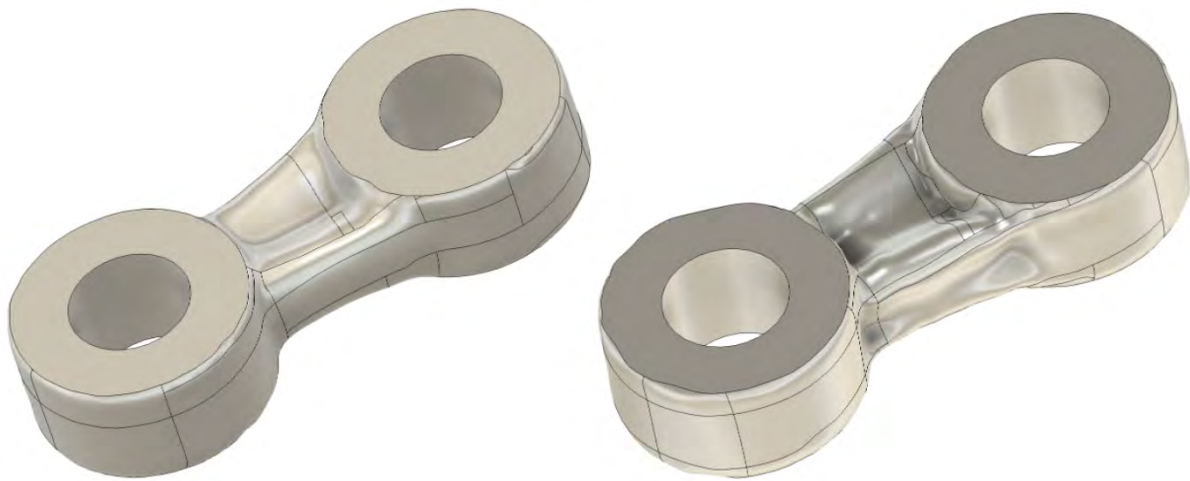
Abbildung 52: Optimierungsergebnisse, links ohne Dickenrestriktion, rechts mit Restriktion der maximalen Dicke
