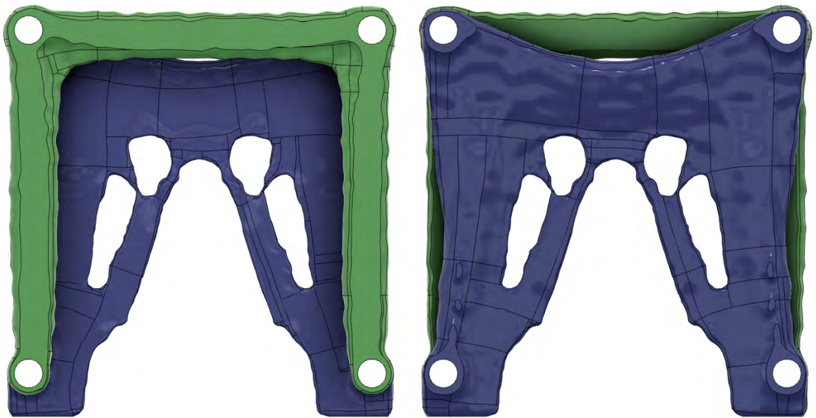
Abbildung 28: Optimierungsergebnisse Apex. Grün uneingeschränktes Ergebnis, Blau mit Überhangswinkelrestriktion und Supportreduktion auf hoch
