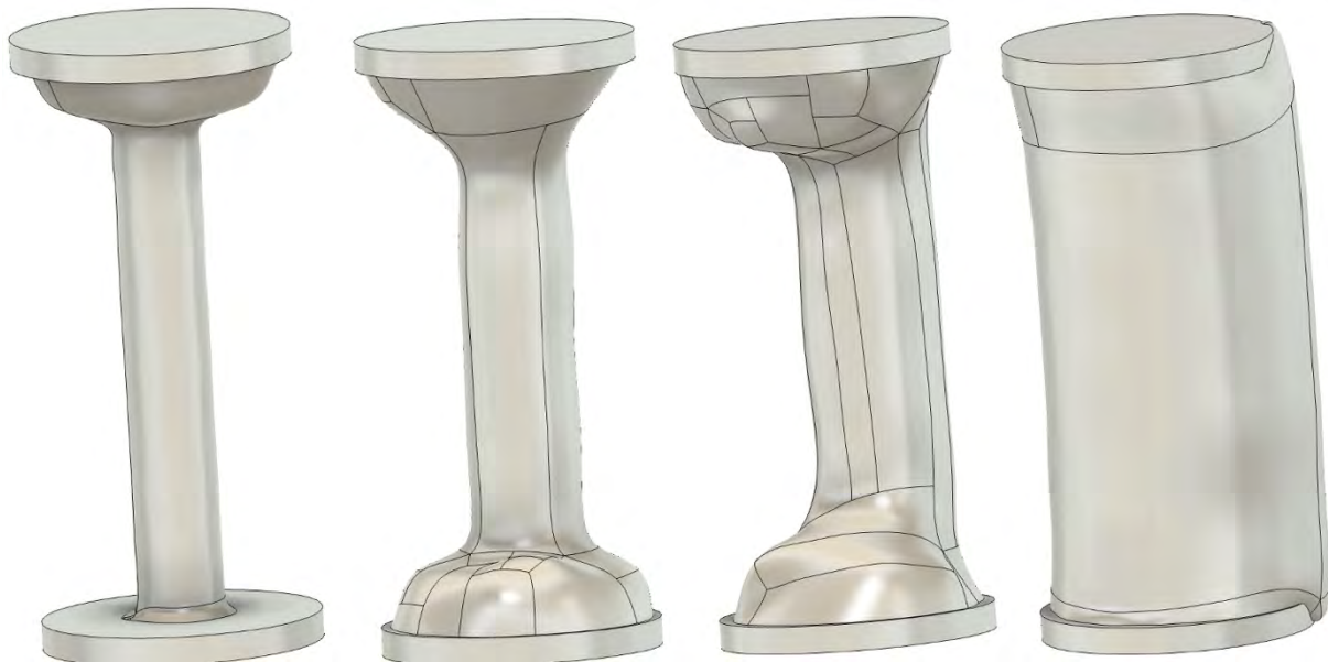
Abbildung 46: Ergebnisse für minimalen Dicke von: 3 mm, 4 mm, 5 mm, 10 mm (von links nach rechts)
