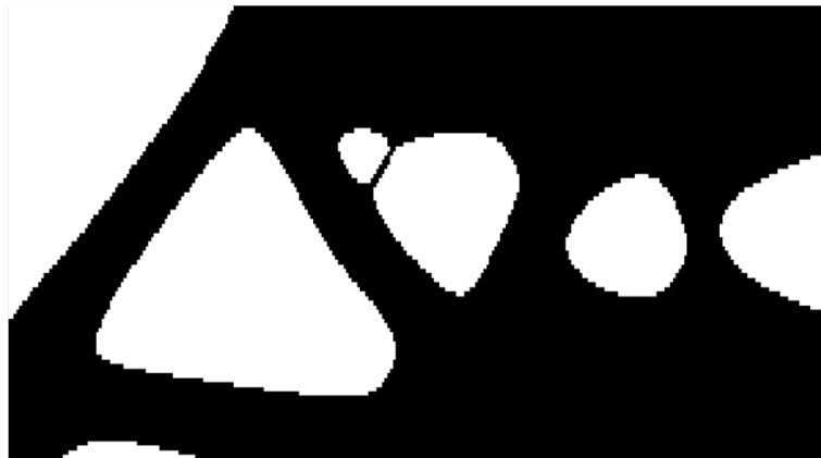
Abbildung 15: Aus der in Abbildung 14 dargestellten Level-Set-Funktion abgeleitete Geometrie
