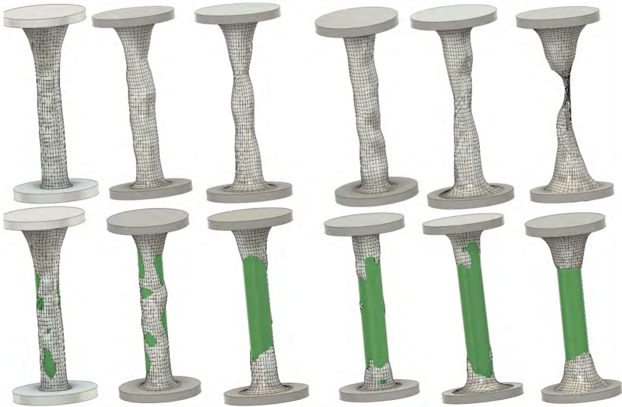
Abbildung 42: Von links nach rechts: Optimierungsergebnisse für vorgegebene Mindestdicken von: 2 mm, 3 mm, 4 mm, 5 mm, 6 mm, 7 mm. Unten mit eingebettetem Zylinder des Durchmessers 3 mm
