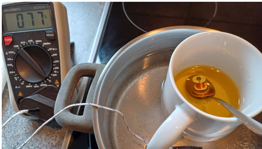
Abbildung 6.15: Tonabnehmerspulen im Wachsbad
