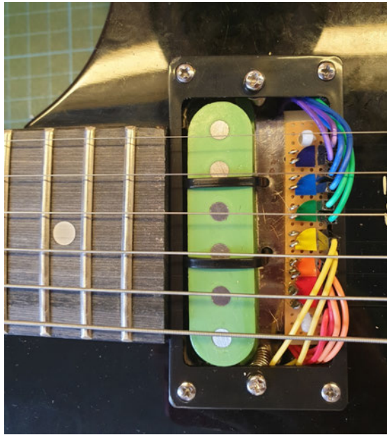
Abbildung 6.10: Eingebauter hexaphonischer Tonabnehmer
