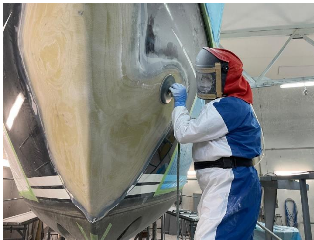
Abbildung 1: Schleifende Oberflächenbehandlung eines GFK-Bugschadens in Schutzausstattung [5]
