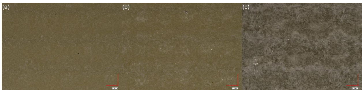
Abbildung 36: Mikroskopaufnahmen der behandelten GFK-Oberfläche mit hundertfacher Vergrößerung: EK F180 (a), F100 (b) und F54 (c)
