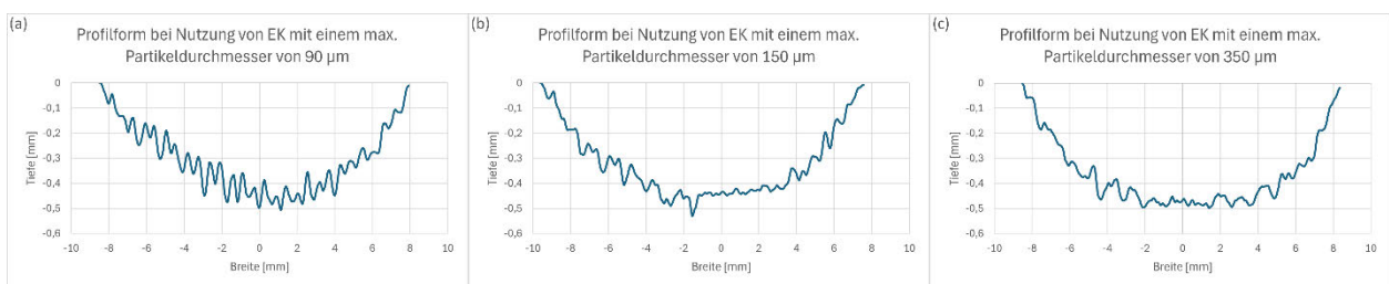
Abbildung 33: Profilformen bei Nutzung von EK mit maximalen Partikeldurchmessern von 90 µm (a), 150 µm (b) und 350 µm (c) bei PA auf GFK
