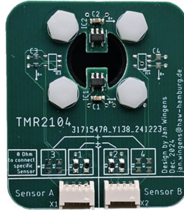
(b) bestückte Platine für den Sensor TMR2104
