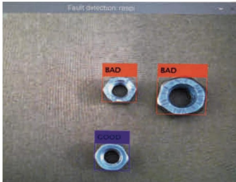
Abbildung 18: Automatisierter visueller Qualitätscheck der Schraubenmuttern[29, S. 19]
