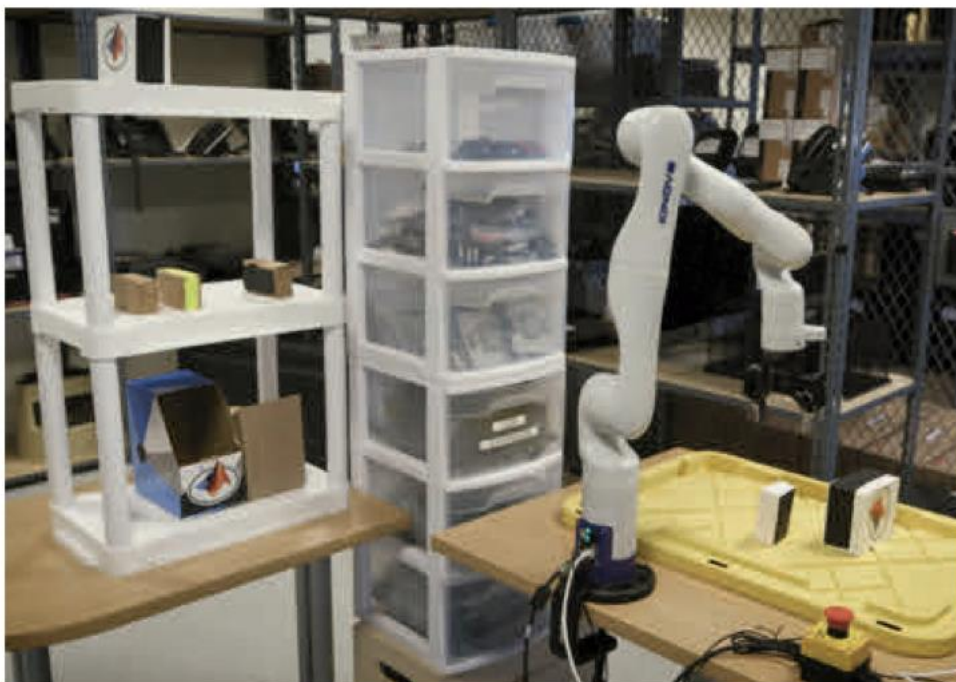
Abbildung 16: Roboterarm detektiert und greift verschiedene Objekte auf[29, S. 28]
