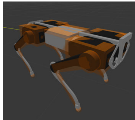
Abbildung 6.4: Visualisierungs- und Kollisionsmodell des Roboters in Gazebo
