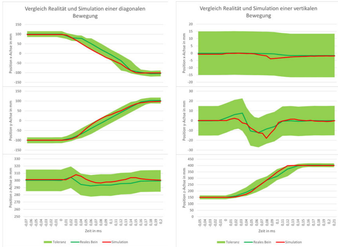
Abbildung 6.5: Darstellung unterschiedlicher Bewegungen in der Simulation und der Realität zur Veranschaulichung der Abweichung der Simulation
