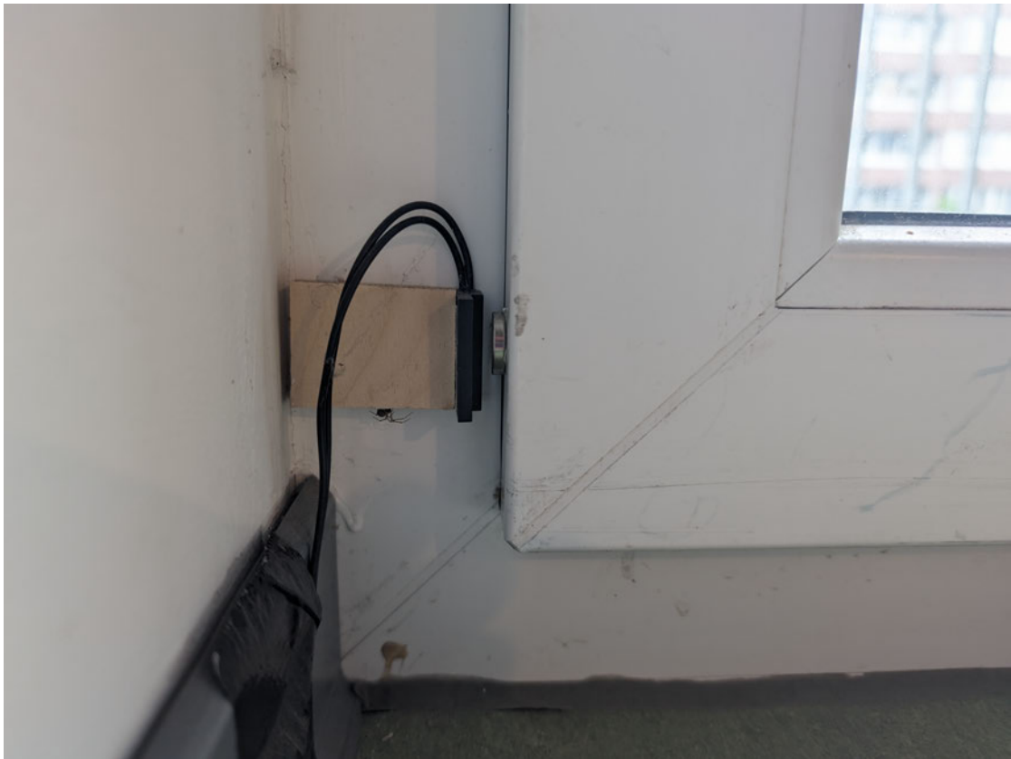
Abbildung A.1: Anbringung des Reedkontakts
