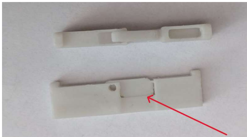
Abbildung 25: 3D-gedrucktes Bauteil ohne Stützstrukturen (Z2u)
