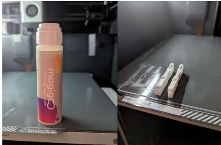
Abbildung 24: Spezieller Klebestift für die Haftung von PP-Filament im 3D-Druck
