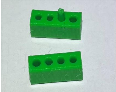
Abbildung 26: Lehre für Positionierungsdübel (eigene Darstellung)
