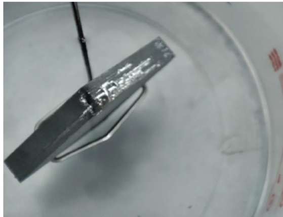
Abbildung 4.9: Probe mit Anhaftungen und Luftblasen
