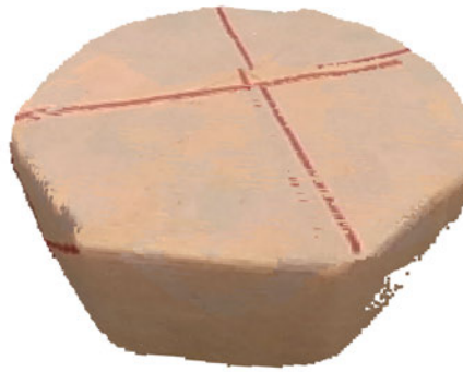
Abbildung 6.33: Paarweise lokale Registrierung eines achtseitigen Volumens
