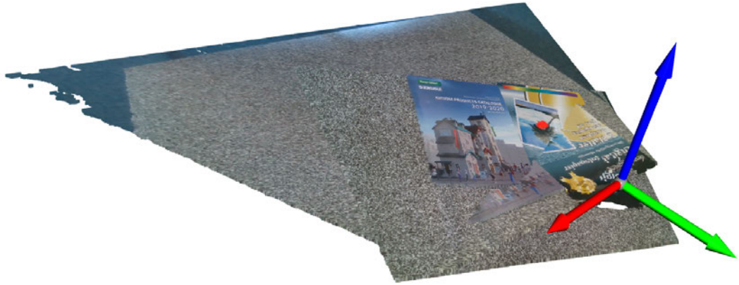
Abbildung 6.14: Mit Feature-Matching ausgerichtete Punktwolke. Grüner Pfeil: X-Achse, roter Pfeil: Y-Achse, blauer Pfeil: Z-Achse
