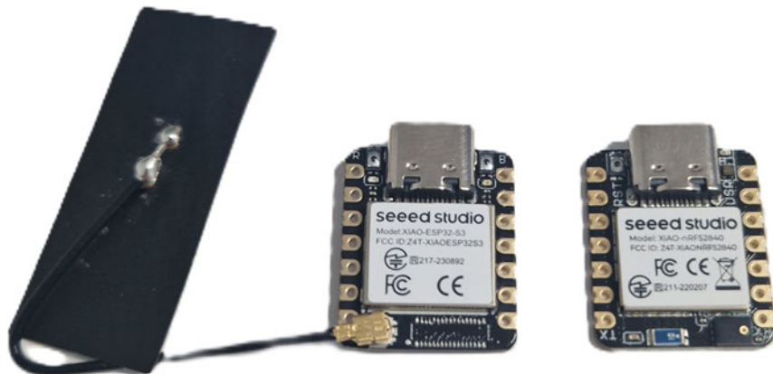
Abbildung 7.3: Vergleichene Mikrocontroller-Modelle des Herstellers Seeed Studio : XIAO-ESP32-S3 und XIAO-nRF52840
