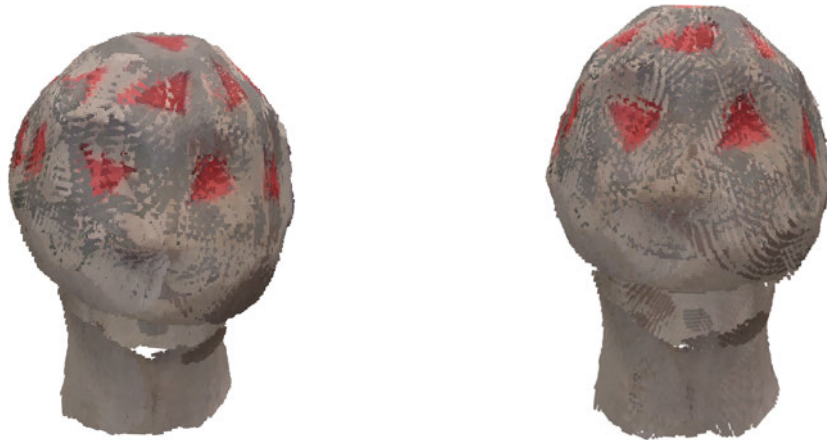
(a) Vereinte Punktwolke vor der Registrierung (b) Vereinte Punktwolke nach der Registrierung
