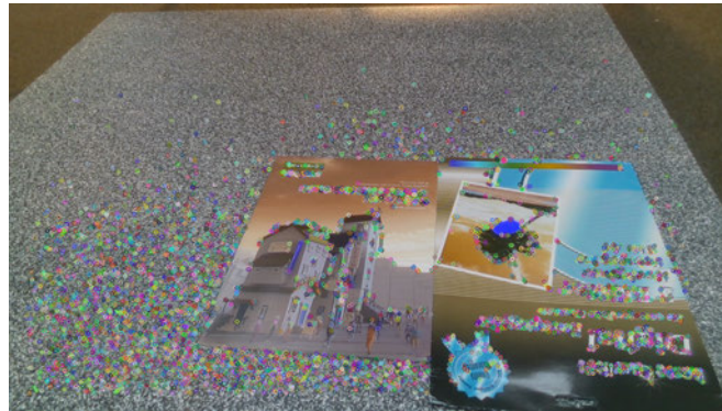
(a) Extrahierte Keypoints: Jede Markierung entspricht einem gefundenen Keypoint
