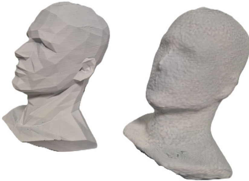
Abbildung 7.7: Vergleich beider Kopfmodelle: Links das Originalmodell und Rechts das gescannte und gedruckte Modell
