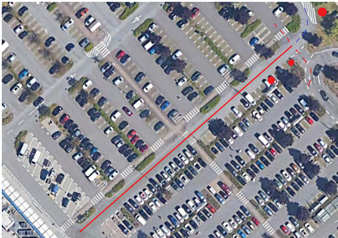
Abbildung 3.2: Parkplatz Ikea Moorfleet ( 53^{\circ}30'42.8''\text{N} 10^{\circ}05'38.2''\text{E} )[3]. Die rote Linie markiert die Teststrecke und die roten Punkte die Orte, an denen der Radarsensor aufgestellt wurde
