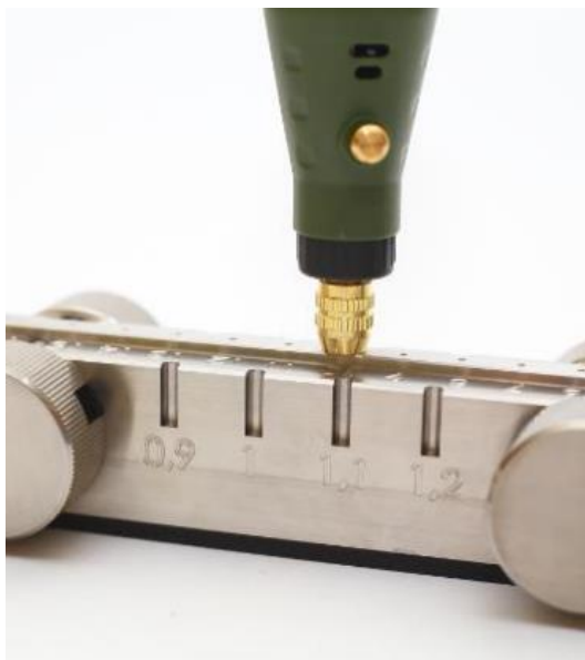
Abb. 21 Vorgehen mit der Bohrschablone für Faserpräparation PFP [12]
