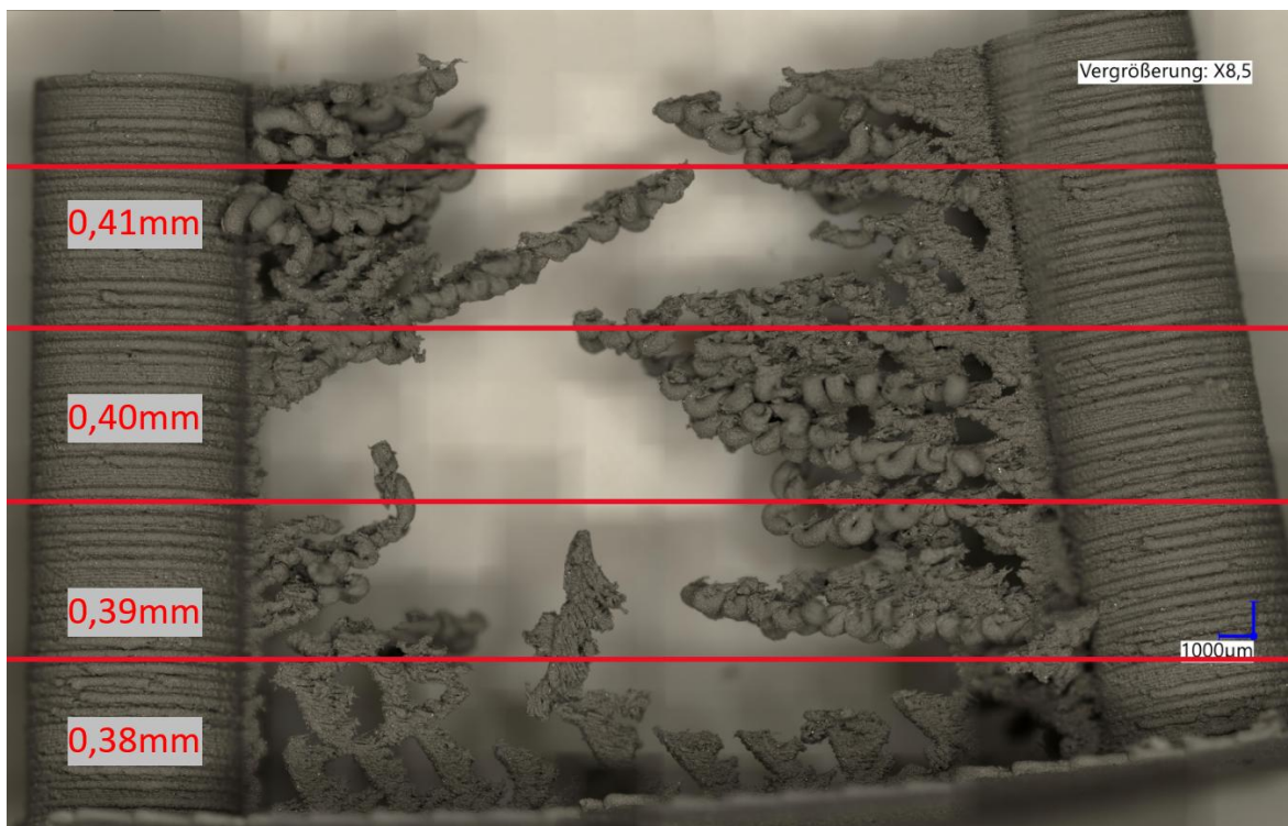
Abbildung 35 Retraction Probe mit 0,38mm bis 0,41mm Mikroskop mit Vergrößerung 8,5
