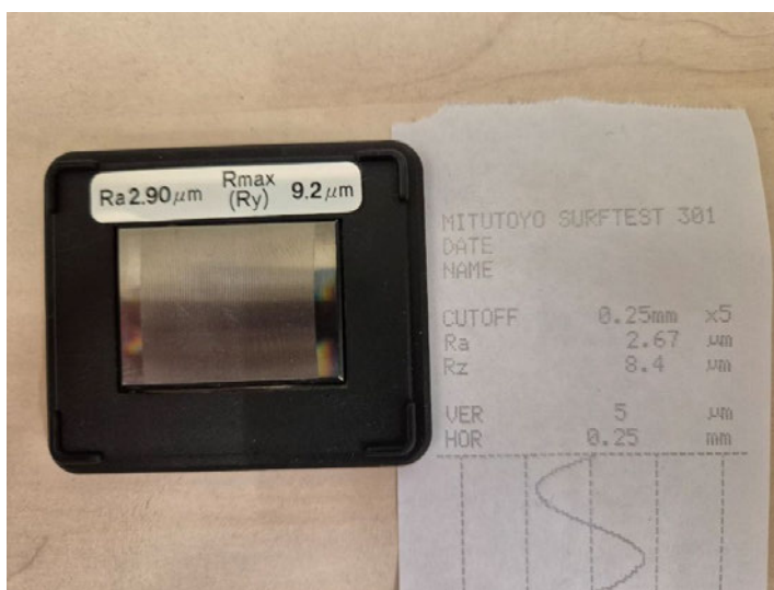
Abbildung 11 Kalibriermessung mit Mitutoyo Surftest 301
