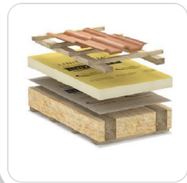
Bsp. Zwischensparre-n & Aufsparrendämmung Hybrit (Warmdach)
