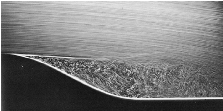
Abb. 2.9: Ablöseblase an einer konkaven Oberfläche: Die (Wasser-)Strömung ist nicht in der Lage der konkaven Kontur zu folgen und löst ab. Es bildet sich ein Totwassergebiet. Die laminare Grenzschicht ist links im Bild als schwarzer Streifen am Körper zu erkennen. Die laminare Strömung setzt sich an der Ablöseblase fort und der Umschlag zur turbulenten Strömung findet in der Scherschicht zwischen freier Strömung und Ablöseblase statt. Aus van Dyke 1997.
