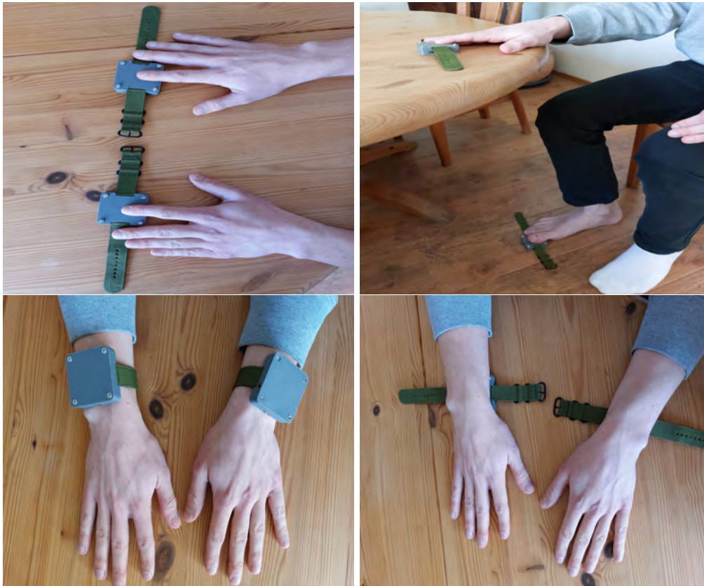
Abbildung 5.1: Abgebildet sind die vier Messpositionen: oben links Zeigefinger zu Zeigefinger, oben rechts rechter Zeigefinger zu rechtem Zeh, unten links die oberen Seiten der Handgelenke, unten rechts die unteren Seiten der Handgelenke.
