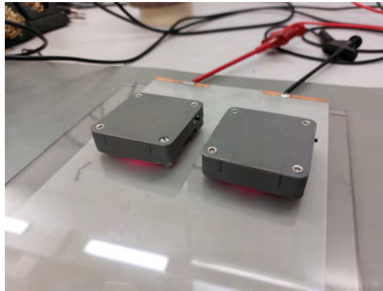
Abbildung 4.2: Versuchsaufbau mit den zwei Sensorknoten und der PDLC-Folie.
