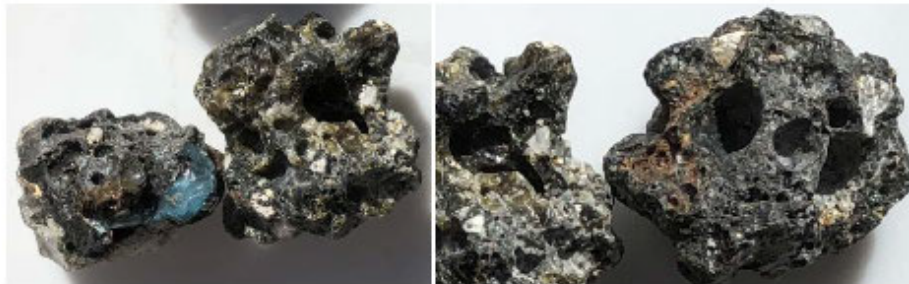
Abbildung 3 Schlackepartikel „porentief rein“ nach der Hochfrequenz-Reinigung (ReUST-System)
