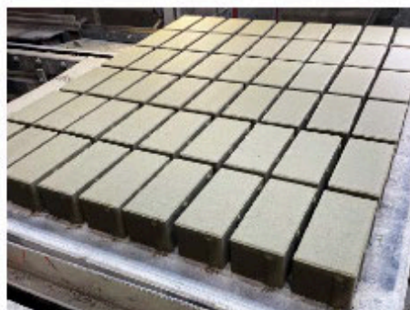
Abbildung 5 Rechtecksteine aus großtechnischer Fertigung mit 17 % UltraLit® im Unterbeton
