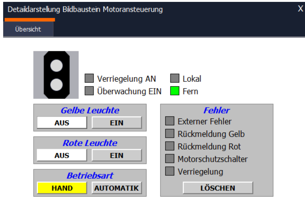
Abbildung 8.2: Bedienoberfläche der Ampelanlage in der HMI
