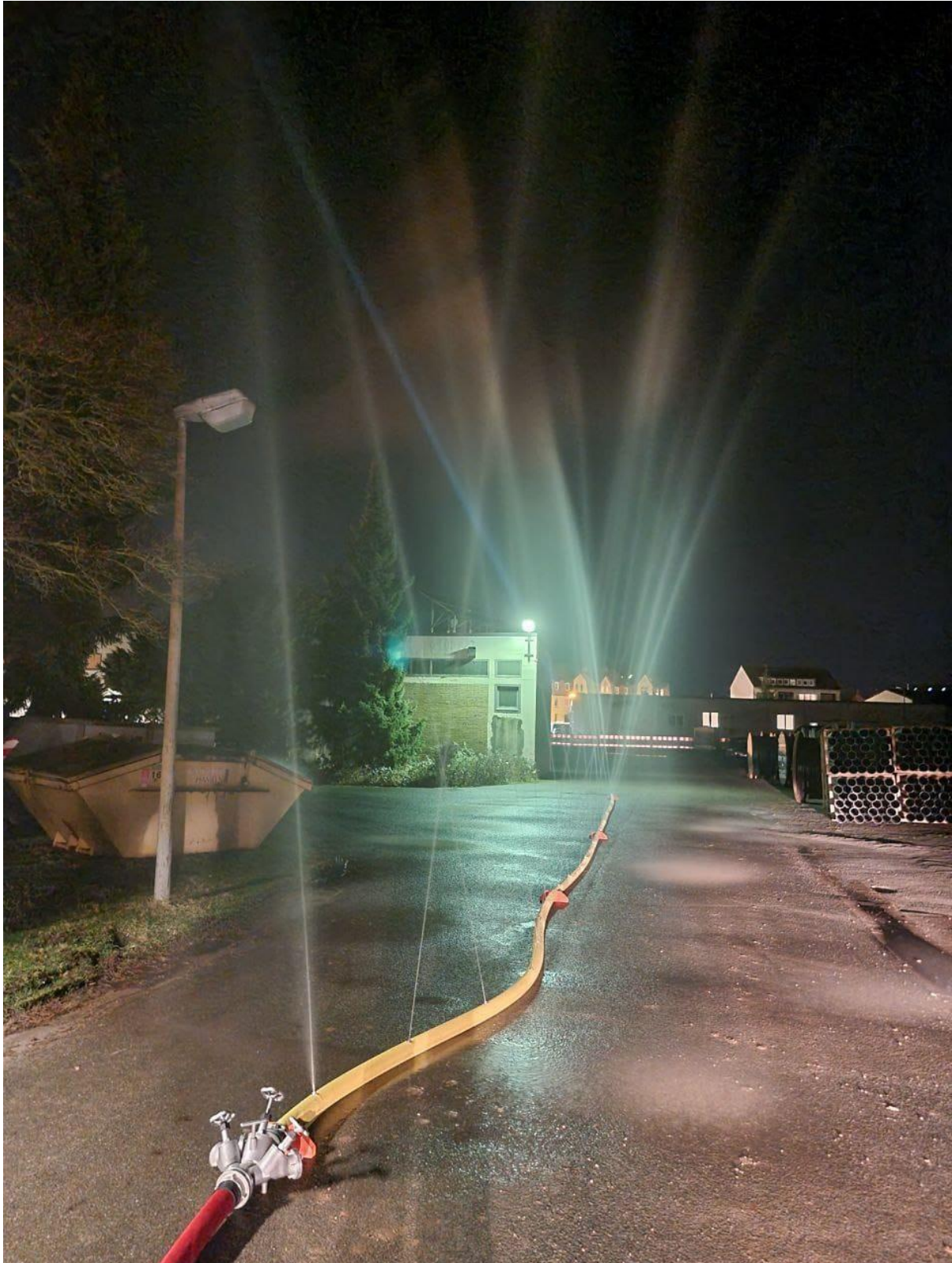
Abbildung 21 Test des Düsenschlauchs der Feuerwehr Hameln (Quelle: Feuerwehr Hameln)
