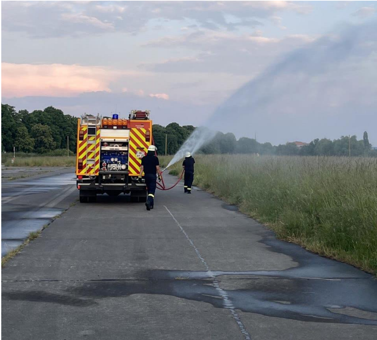
Abbildung 20 Pump-and-Roll-Betrieb des LF 20 der FF Hameln mit festem Rohr am B-Abgang und einem handgeführten Rohr (Quelle: Feuerwehr Hameln)
