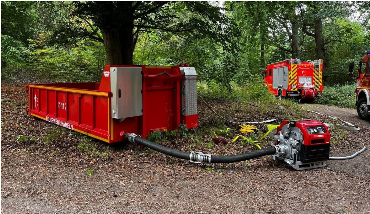
Abbildung 24 Übergabestelle des Pendelverkehrs mit dem AB-Mulde (Quelle: Feuerwehr Hameln)
