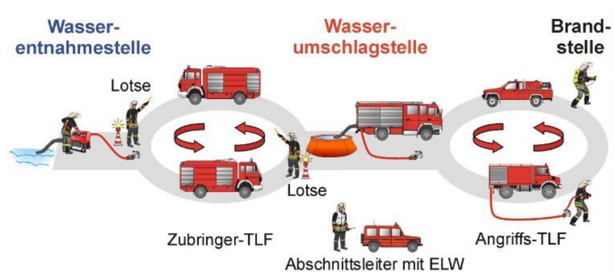
Abbildung 26 Schematischer Aufbau des doppelten Pendelverkehrs (Cimolino, 2014, p. 246)
