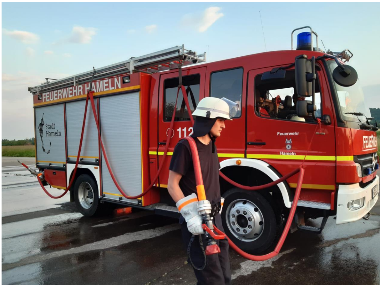
Abbildung 22 Befestigung eines Schlauches am LF 20 der FF Hameln, ohne die Mobilität einzuschränken (Quelle: Feuerwehr Hameln)
