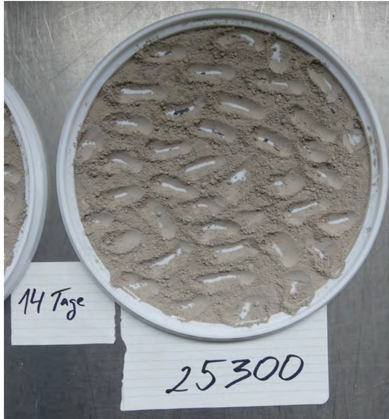
Abbildung 12: Die Probe 25300 nach der Entnahme der Teilprobe nach 14 Tagen Lagerung im Klimaschrank (eigene Aufnahme)
