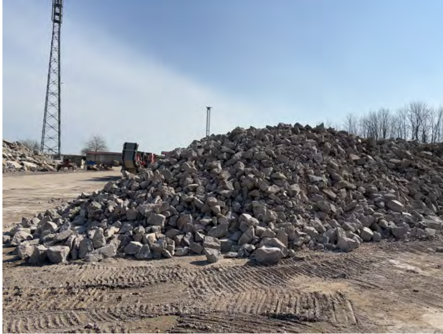
Abbildung 3: Der Betonbruchhaufen, von welchem die groben Proben stammen (Quelle: Katrin Rost, zur Verfügung gestellt)
