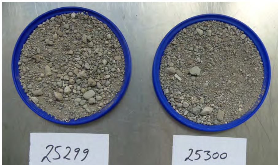
Abbildung 10: Die feinkörnigen Teilproben vorbereitet für die Lagerung im Klimaschrank, samt Probennummern (eigene Aufnahme)
