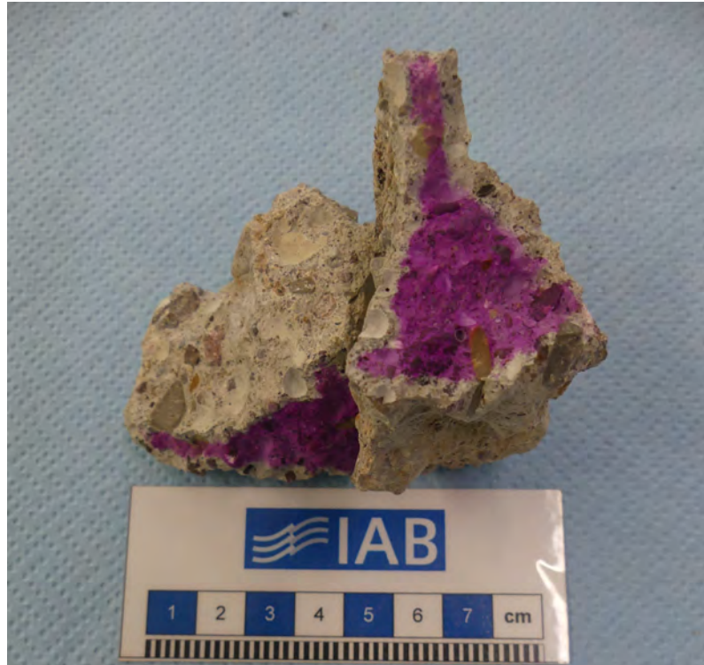
Abbildung 15: Die besprühte Bruchfläche mit deutlich sichtbarem Rand (eigene Aufnahme)
