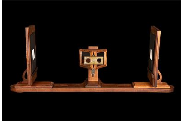
Abb. 2.7: Reflektierendes Stereoskop nach Charles Wheatstone. (Europa-Universität Flensburg, 2023)
