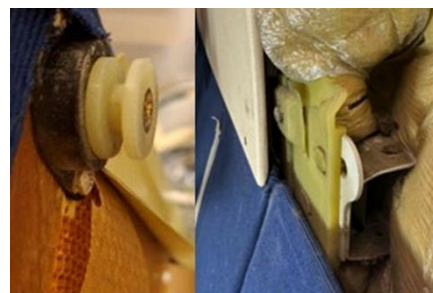
Abbildung 9 : Befestigung von Dado Panel und Sidewall Lining. Links: Befestigung an Panel, rechts an Primärstruktur.
