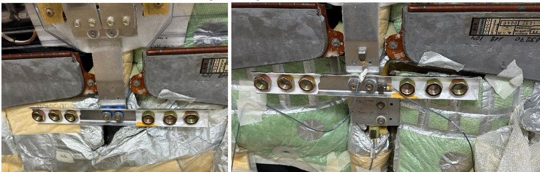
Abbildung 31 : Messaufbau von 3D gedruckte Isolatoren in VIP Kabine Demonstrator (Links : Serenisolatoren, Rechts: TPU70A Isolatoren).
