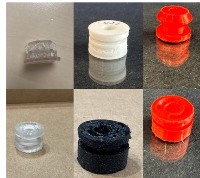
Abbildung 30 : Parametrisch gestaltete 3D-gedruckte Isolatoren aus verschiedenen Materialien (Rot: TPU45D, Weiß: TPU70A, Schwarz: TPU85A und Transparent: Resin70A).
