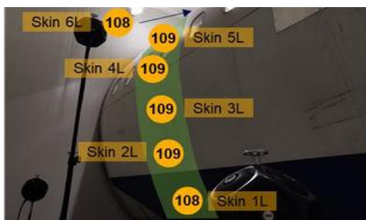
Abbildung 4 : Anregung der Akustikklammer mit drei Dodekaeder Lautsprechern, Übersicht Schalldruckpegel in Akustikklammer und Kabine mit Positionsangabe.
