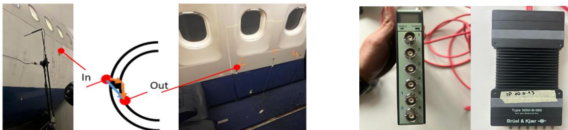
Abbildung 23 : Beispielaufbau für die Unterscheidung von Luft- und Körperschall (Link). 6 Kanälen LAN-XI Module (Recht).
