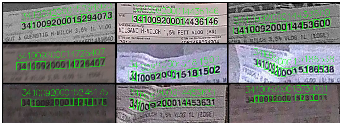
Abbildung 6.8: Korrekte Erkennung von NVE mit YOLOv9 und LeNet-5 (eigene Darstellung)
