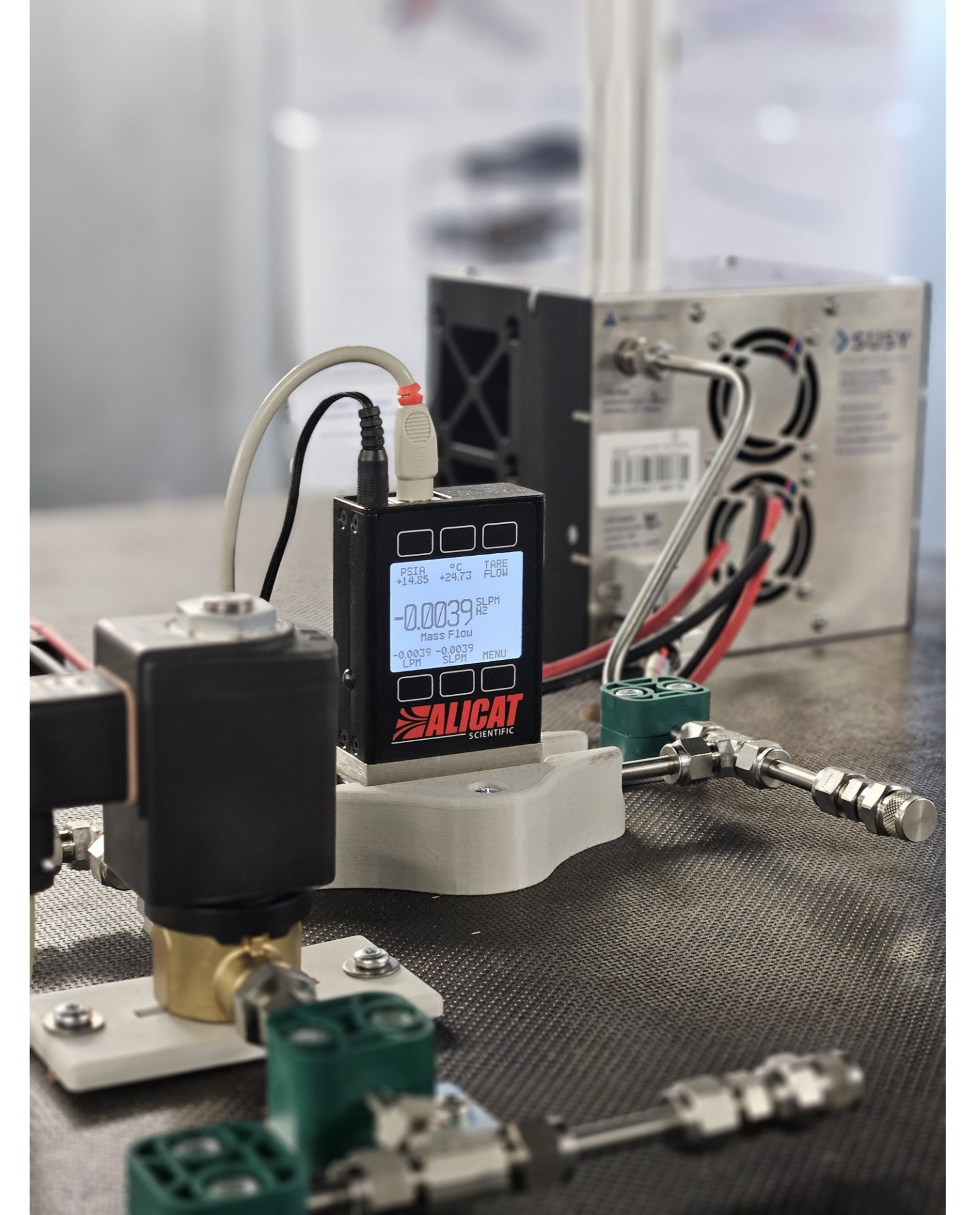
Wasserstoffversorgung und Brennstoffzelle des BeHyPSy- Teststands an der HAW Hamburg
