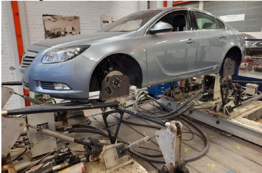
Servo-hydraulischer Multi-Exciter bis 25Hz (Bild: HAW Hamburg)
