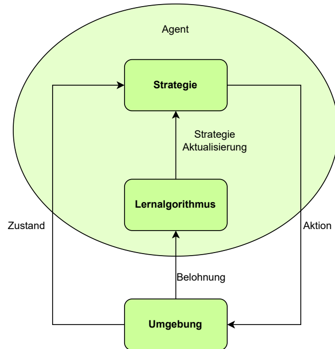
Abbildung 2.4: Grundstruktur eines Reinforcement-Learning-Systems
