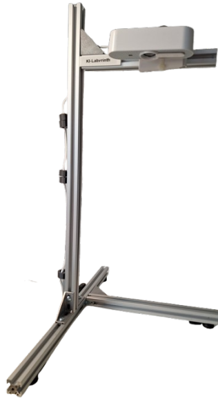
Abbildung 3.2: Kameragestell mit befestigter Webcam zur Top-Down-Erfassung [15]
