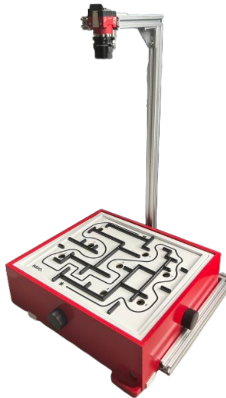
Abbildung 6.2: Physischer Aufbau der Kameraintegration oberhalb des Kugellabyrinths
