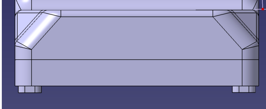
Abbildung 37.: Kanten zum Verhindern von übermäßigem Kippen
