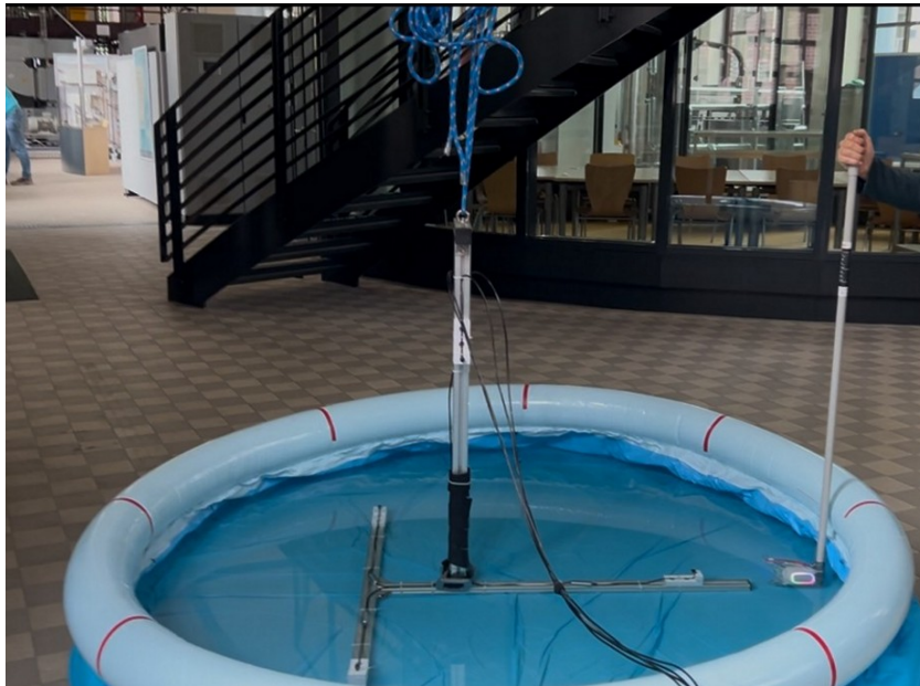
Abbildung 6.2: Hydrophon-Array mit Lautsprecher
