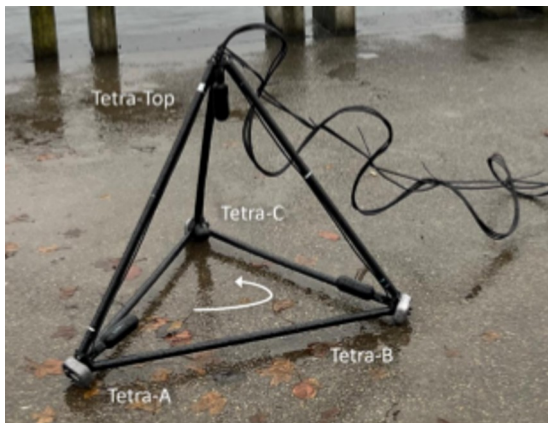
Abbildung 2.3: Tetraedrischen Hydrophon-Array. Bildquelle: [19]
