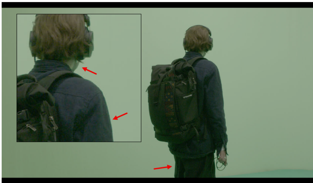
Abbildung 16: Standbild der Studiokamera mit Hervorhebung des Green Spill
